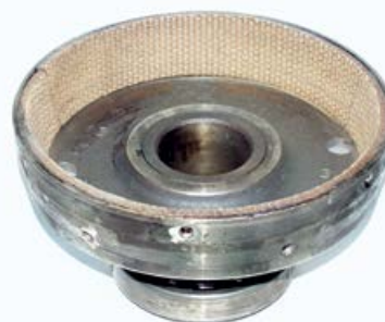
Kuželová spojka vnitřní D430xD405x8 SWR
