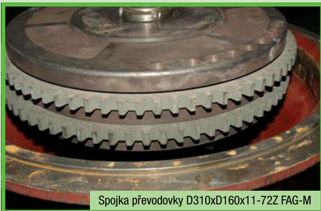
Třecí lamela D310xD160x11-72Z FAG-M
