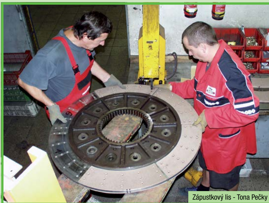
Třecí segment kovokeramický 67x112x11
