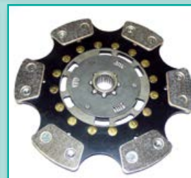
Úprava spojkové lamely ŠKODA FABIA TDi RS
