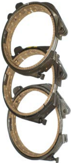
Třecí pás měniče bus DOUBLE DECKER
