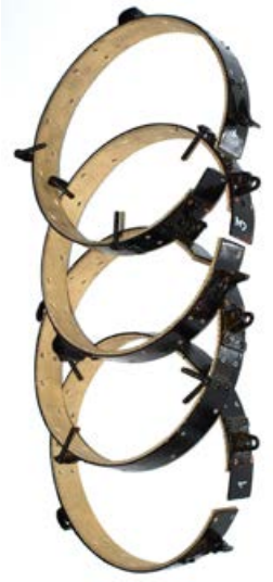
Pásová brzda BUICK MASTER SIX
