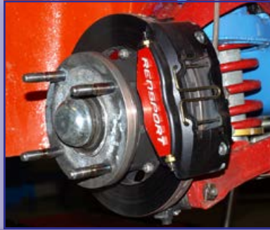
Brzdová soustava RENSSPORT homologovaná do silničního provozu a pro Mistrovství České republiky pro skupinu HA, vozidla Škoda typy 100,110,110R,120,125,130,130RS,136L Rapid
