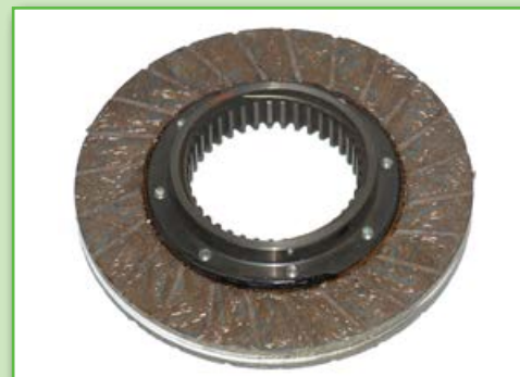
Lamela stroje na výrobu hřebíků D170x12 HDS57
